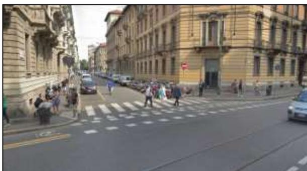
*Nel caso di corsie e bande ciclabili in carreggiata non è in genere richiesto il disegno dell’attraversamento. Può essere utile in caso di disegno di percorsi che si vuole fortemente caratterizzati, per attraversamenti prioritari o in caso di scarsa visibilità dalle strade laterali (Milano, via Carducci).*
