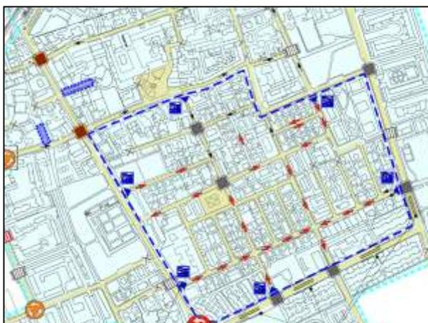
*Nelle zone residenziali devono essere realizzate tre fondamentali condizioni: volumi di traffico modestissimi, totale assenza di flussi di attraversamento e di veicoli pesanti, impossibilità fisica di superare i limiti di velocità da parte del traffico motorizzato.*
