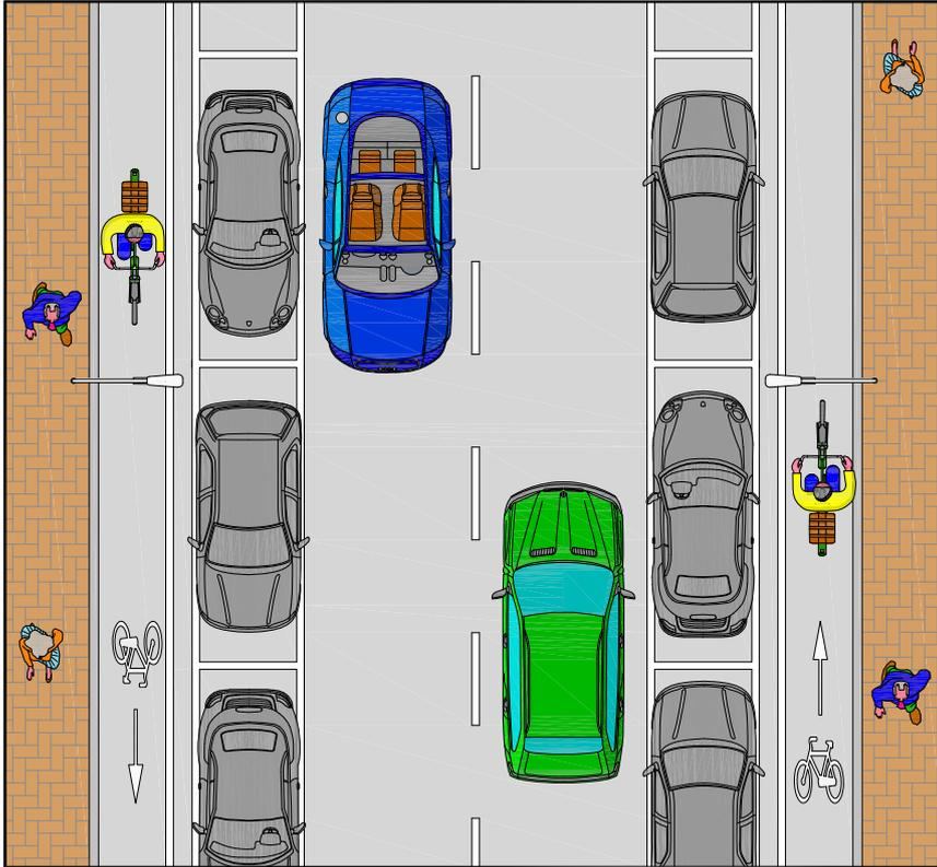
**Pista ciclabile monodirezionale** ricavata direttamente sulla carreggiata e separata dal traffico veicolare attraverso l'inserimento di stalli di sosta.
