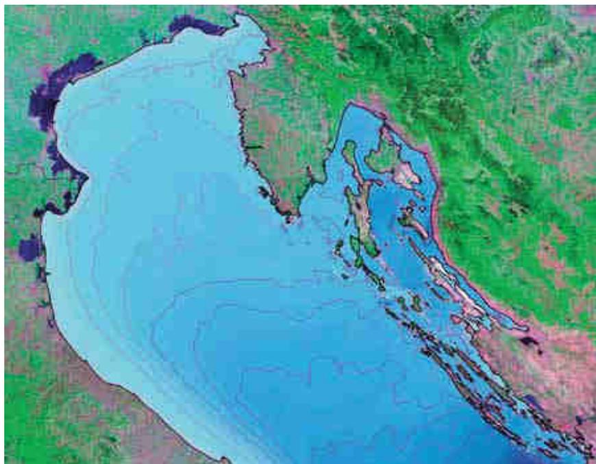
Figura 9. Modello digitale del fondo marino ottenuto per interpolazione dei rilievi batimetrici.
