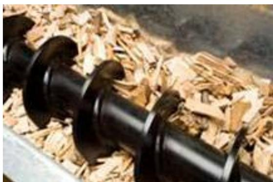
di una fornitura di cippato è la dimensione prevalente delle singole schegge. Le caldaie a griglia fissa necessitano di un cippato di elevata qualità quanto a **pezzatura**, che deve essere omogenea (P16, P45, cfr. tabella), sia per la ridotta dimensione della griglia sia perché pezzi fuori misura possono essere causa di blocchi alle coclee di trasporto e di caricamento. I generatori di maggiore potenza con sistemi di caricamento a spintore sono
