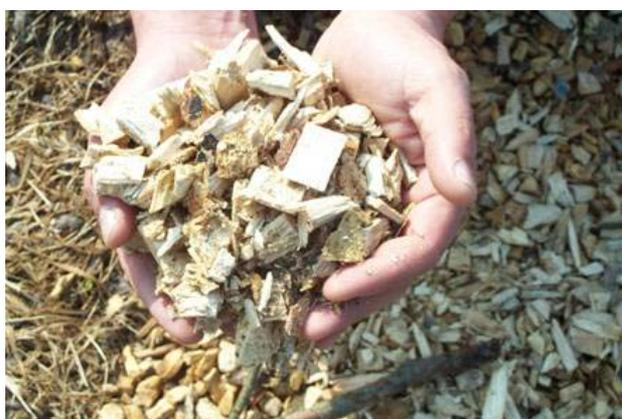
La pezzatura del cippato è funzione del **tipo di materiale di partenza** (ramaglie, cimali, tronchi) e del **tipo di cippatrice**, che deve essere quindi scelta in funzione della classe di pezzatura che si vuole ottenere. Le cippatrici attualmente sul mercato, sono munite di appositi vagli interni che garantiscono una maggiore omogeneità del cippato e una ridotta frazione dei fini (poco tollerati dalle piccole caldaie), in particolare quando il materiale di partenza è eterogeneo.
