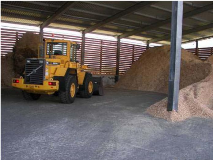
Il cippato M30 così prodotto può essere conferito direttamente all'impianto oppure deve essere stoccato sotto una **copertura ventilata** costruita su fondo impermeabile. Presso la piattaforma è indispensabile la presenza di una **pala meccanica** dotata di benna specifica per cippato per il carico del cippato sui mezzi di trasporto, es. autotreno con cassoni.
