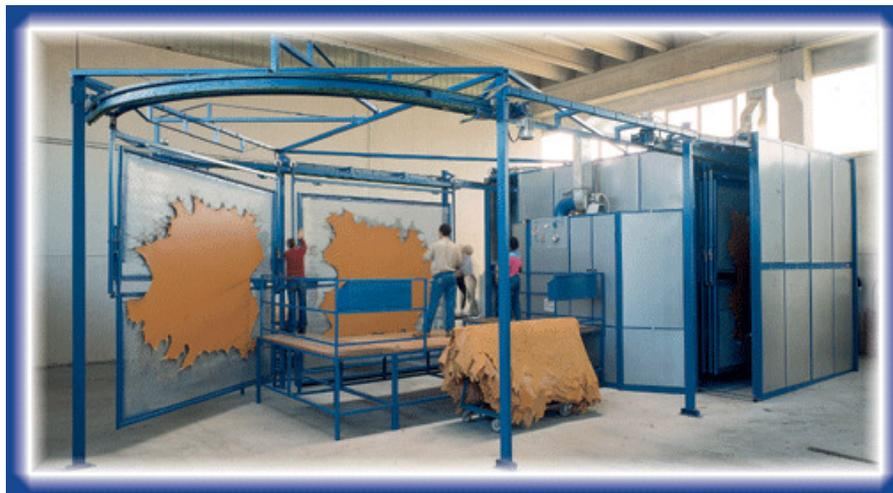
A corredo è presente un sistema di movimentazione automatica dei telai all'interno/esterno del tunnel di essiccaggio;
