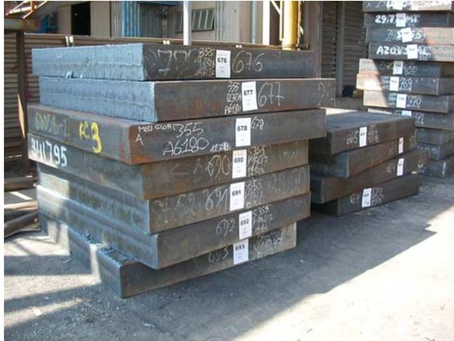
Le lamiere si ottengono tramite laminazione a caldo della materia prima costituita da bramme di acciaio al carbonio bassolegato che vengono scaldate alla temperatura di laminazione di circa 1250 °C in un forno di riscaldamento che utilizza gas-metano come fonte di energia. Raggiunta la temperatura di laminazione, le bramme sono trasferite in automatico al laminatoio dove sono laminate in ciclo continuo alle dimensioni programmate.
