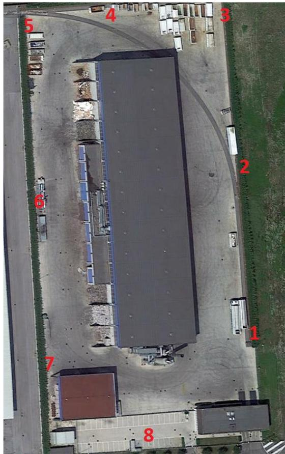
Figura 5-1- Punti di prelievo degli otto campioni in aria ambiente al perimetro dell'impianto. Fonte: Piano di Monitoraggio e Controllo 2020. ALLEGATO 4: Relazione tecnica misura concentrazione odore
