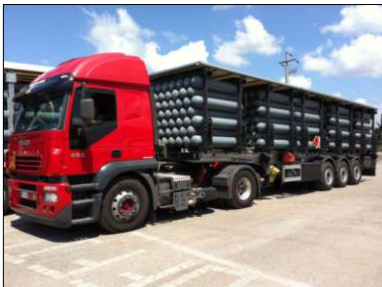
Figura 3-10 Esempio di carro bombolaio usato per il trasferimento di biometano
