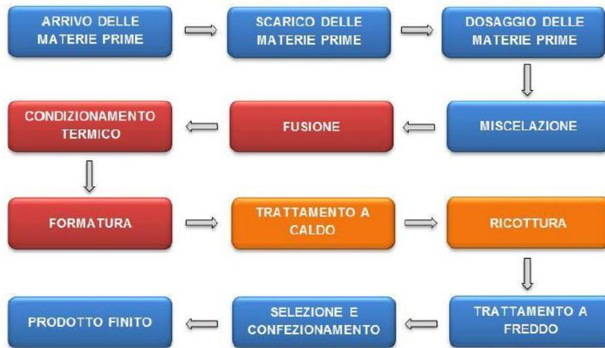
Figura 8 - Schema a blocchi del processo
