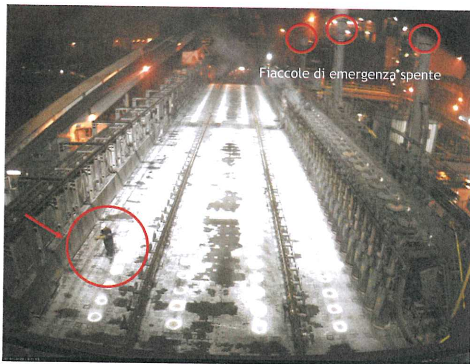
Fig. 2 – Visione del piano di carica alle ore 19:15 con evidenza di personale al lavoro ed evidenza delle fiaccole spente in assenza di pioggia e pertanto di non fumosità del piano di carica
