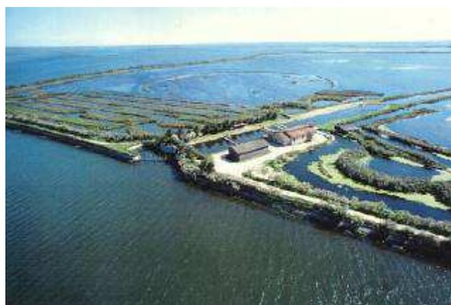
**Figura 31.** Le valli da pesca sono porzioni arginate di laguna e dotate di chiuse regolabili per la taratura dei livelli idrici e l'entrata/uscita del pesce.
