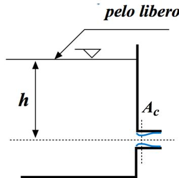
Fig. 1: Schema di serbatoio con tubo addizionale esterno.
