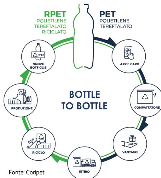
Figura 2.3 – Esempio di sistema *bottle to bottle*
