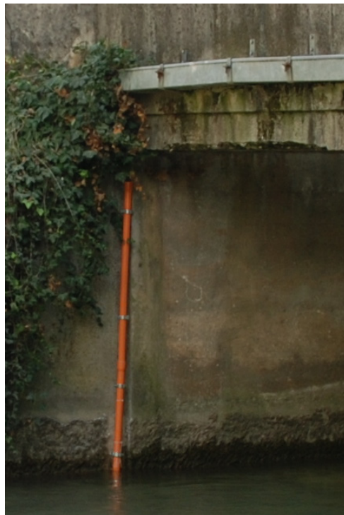
Figura 6.3.3: a sinistra: l'idrometro di Barazzetto. A destra: l'idrometro di Zompicchia. Il tubo arancione protegge lo strumento e lo mantiene in posizione
