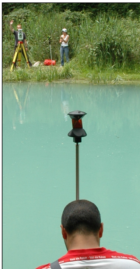
Figura 6.3.9: (a sinistra) esecuzione di misure topografiche tra le sponde del torrente Corno; (a destra) sezione topografica rilevata, con quote riferite alla superficie liquida
