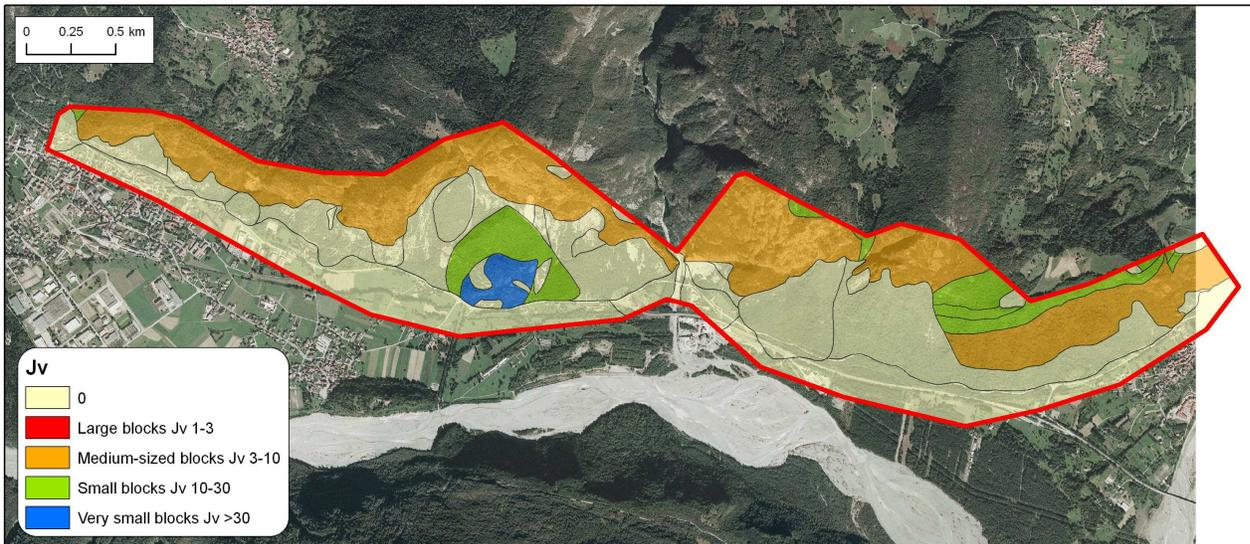
**Figura 4.16: Carta della fratturazione degli ammassi rocciosi.**
