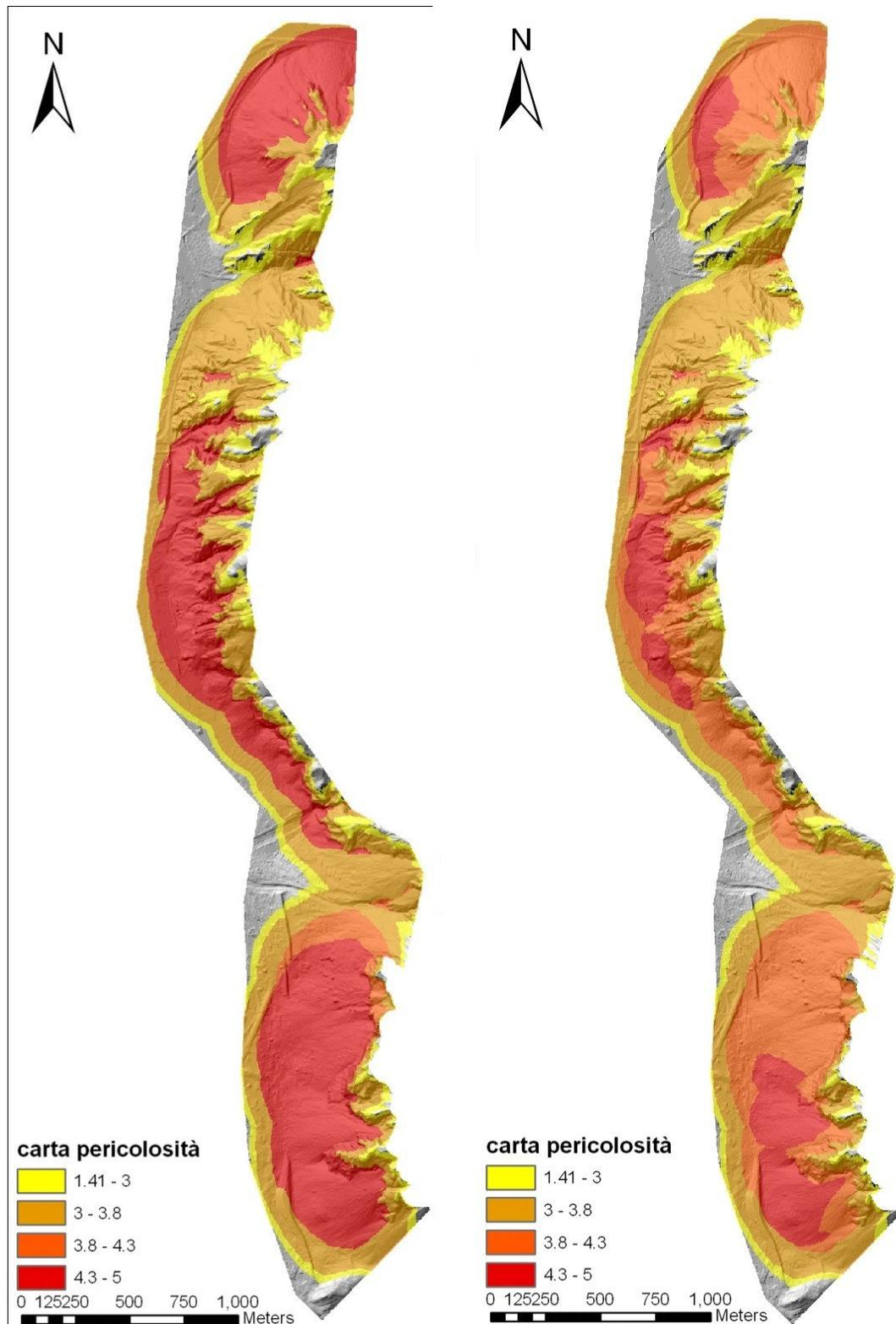
**Figura 7.26:** carte di pericolosità ottenute con l'approccio del cono d'ombra. A) sorgenti lineari  $\phi=28^\circ$ ; B) sorgenti lineari  $\phi=28^\circ$  e  $\alpha \pm 15^\circ$  C) sorgenti lineari  $\phi=33.5^\circ$  D) sorgenti lineari  $\phi=33.5^\circ$  e  $\alpha \pm 15^\circ$  E) sorgenti areali  $\phi=28^\circ$ ; F) sorgenti areali  $\phi=28^\circ$  e  $\alpha \pm 15^\circ$  G) sorgenti areali  $\phi=33.5^\circ$  D) sorgenti areali  $\phi=33.5^\circ$  e  $\alpha \pm 15^\circ$
