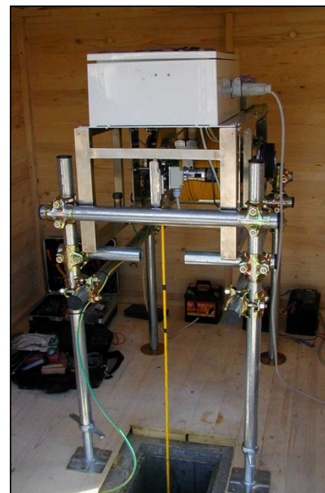
Fig.7: SISIFO: profilatore inclinometrico a controllo remoto.
