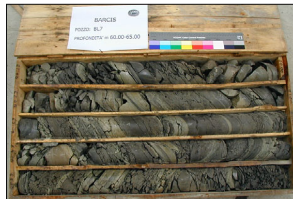
Fig.3: Carote di flysch del sondaggio geognostico BL7.
