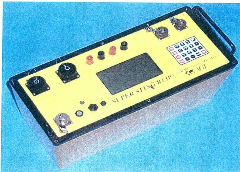
Figura 2 - Georesistivimetro "SUPERSTING R1/IP"
