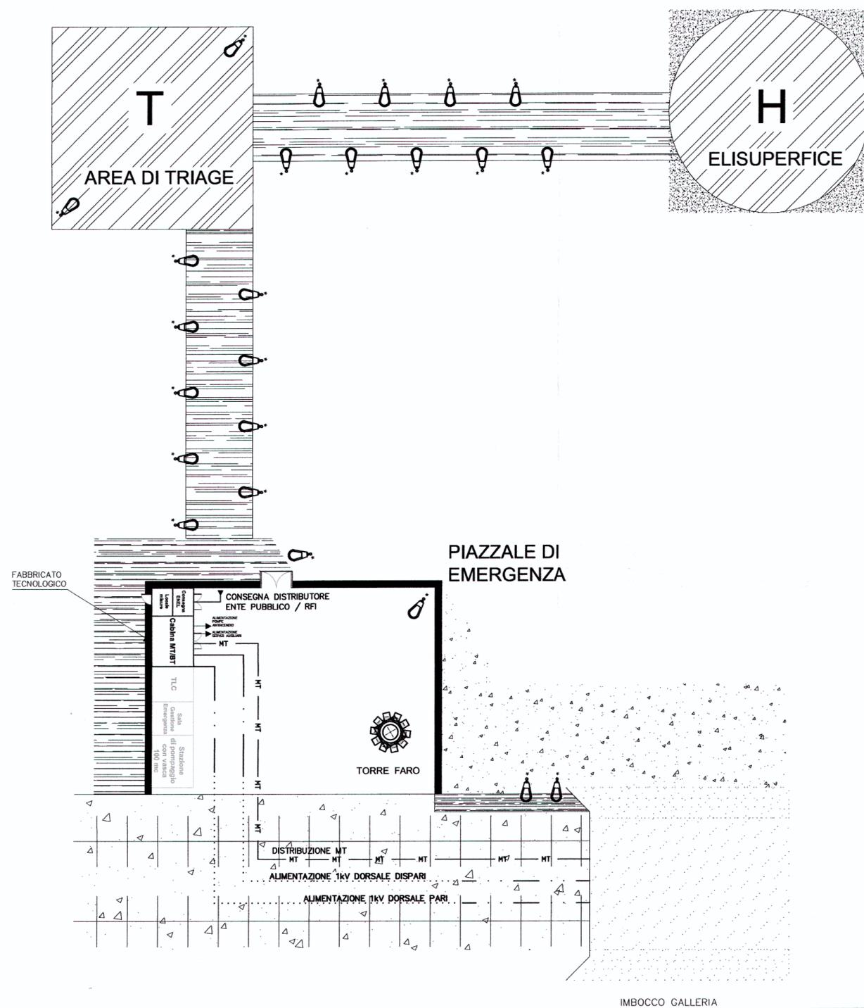
L'elaborato prodotto vuole indicare le aree in prossimità dell'imbocco di galleria, ovvero il piazzale di emergenza l'area di triage (può essere anche adiacente al piazzale), l'elisuperficie e la viabilità, mettendo in evidenza le utenze che vengono alimentate dagli impianti LFM
