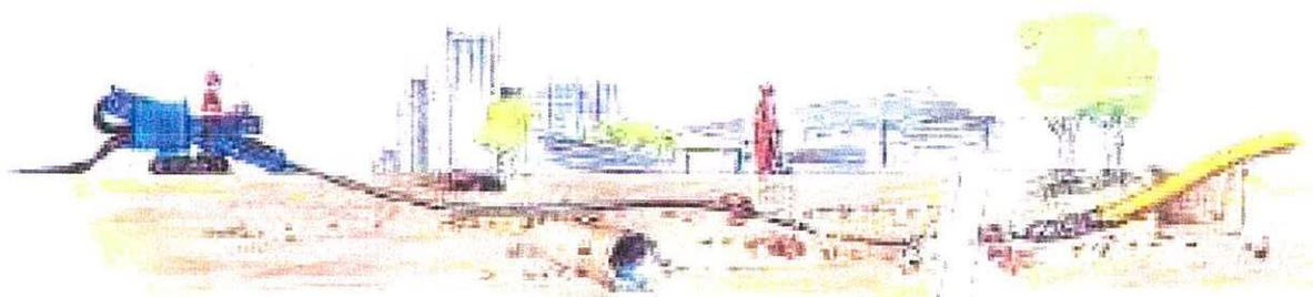
Metodo di perforazione teleguidata
