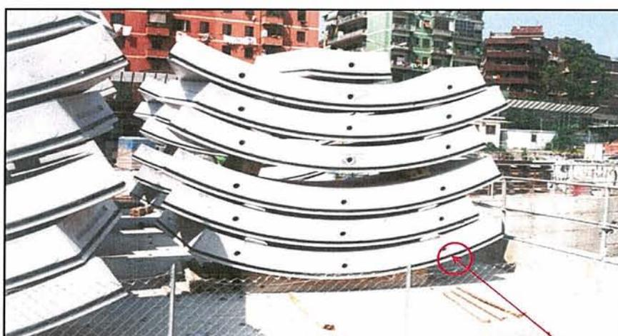
Fig. 5.3 – Conci prefabbricati con guarnizioni in neoprene a tenuta idraulica
