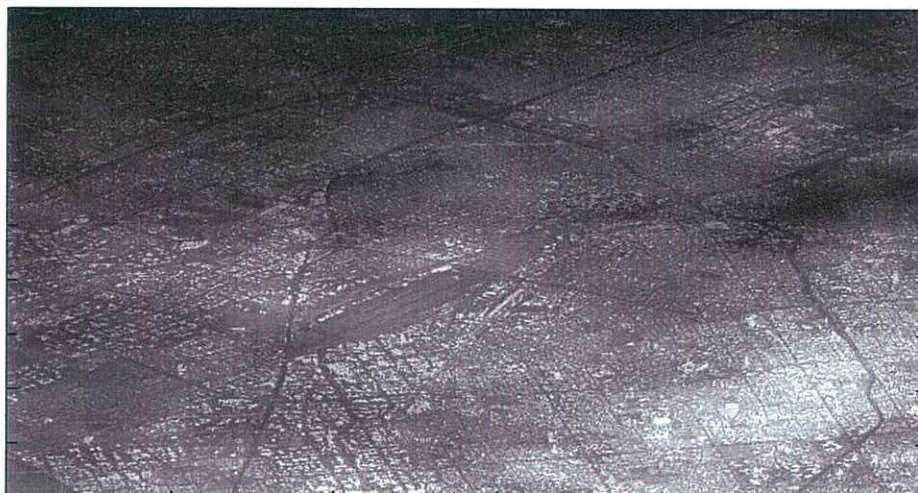
Figura 11: Componente atmosferica di fase sovrapposta all'immagine di ampiezza.
