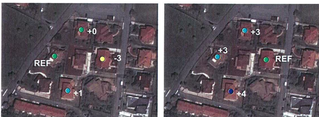
Figura 39: cambio di reference point. Nelle due immagini sono illustrate le velocità dei singoli PS utilizzando due punti di riferimento differenti. Da notare come indipendentemente dal punto scelto come riferimento, le differenze relative di velocità tra PS non cambiano.
