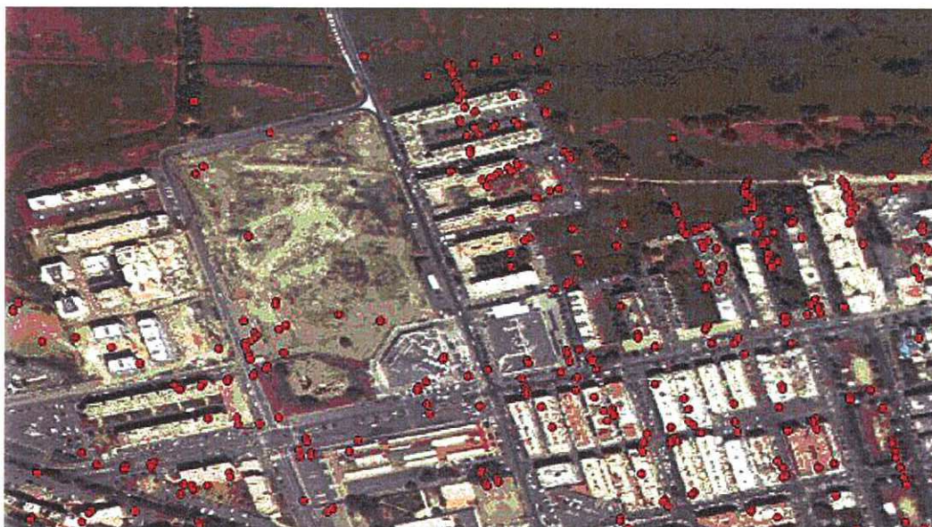
Figura 40: Disposizione dei PS non consistente con il layer usato come supporto cartografico.
