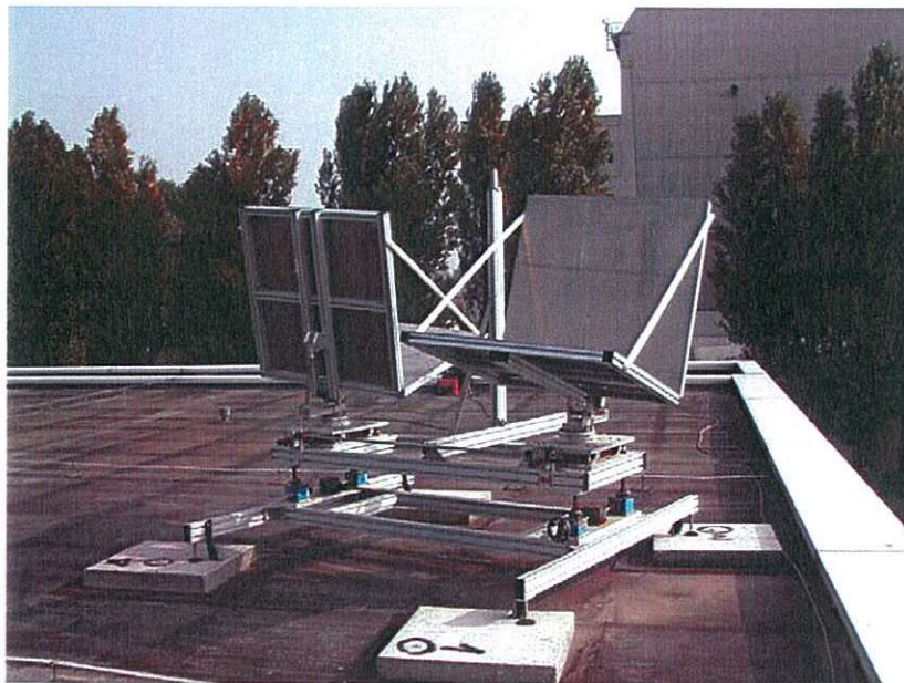
Figura 22: Coppia di riflettori artificiali usati durante l'esperimento. Il basamento di questa struttura è dotato di un meccanismo di movimentazione in direzione verticale e longitudinale.
