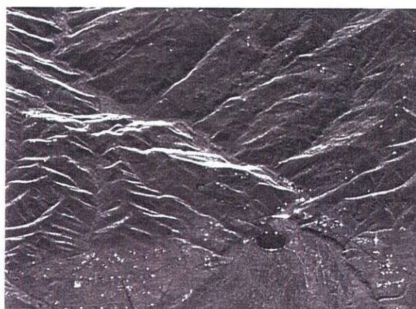
Figura 7: Fenomeni di deformazione prospettica in immagini focalizzate SAR. Al centro della figura, versanti in foreshortening (linee bianche).
