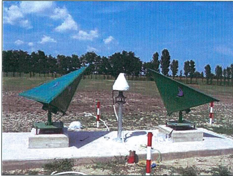
Figura 24: Coppia di corner reflector montati in configurazione tale da essere contemporaneamente visibile dal satellite in modalità ascendente e discendente. Sul basamento comune è stata predisposta un'antenna GPS. Attraverso questo schema di installazione è possibile rendere "assolute" tutte le misure PS che, invece, per loro natura sono di tipo differenziale.
