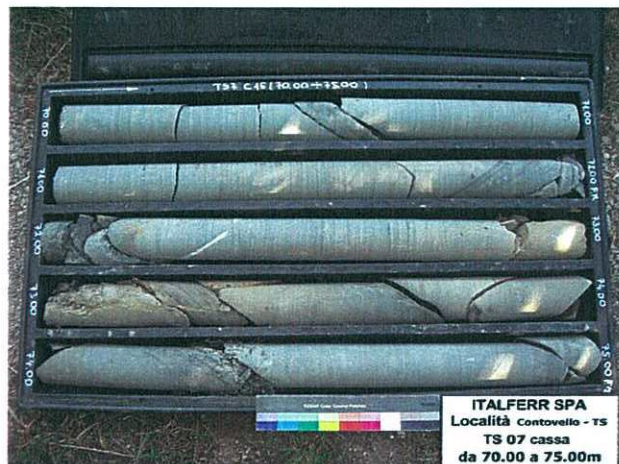
Fig. 9.6- Foto sondaggi TS6 e TS7 a quota galleria (risp 130m e 70m da p.c.) - Arenarie e Marne argillose (TS6) e Marne e Arenarie (TS7)
