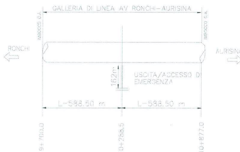
Fig. 8.16 – Schema uscita/accesso di emergenza per galleria di linea AV - subtratta Ronchi Aurisina (GA07+GN02+GA08)
