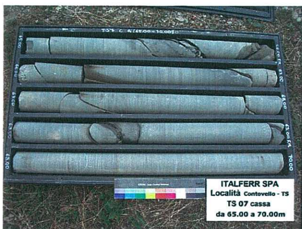
Fig. 9.6- Foto sondaggi TS6 e TS7 a quota galleria (risp 130m e 70m da p.c.) - Arenarie e Marne argillose (TS6) e Marne e Arenarie (TS7)
