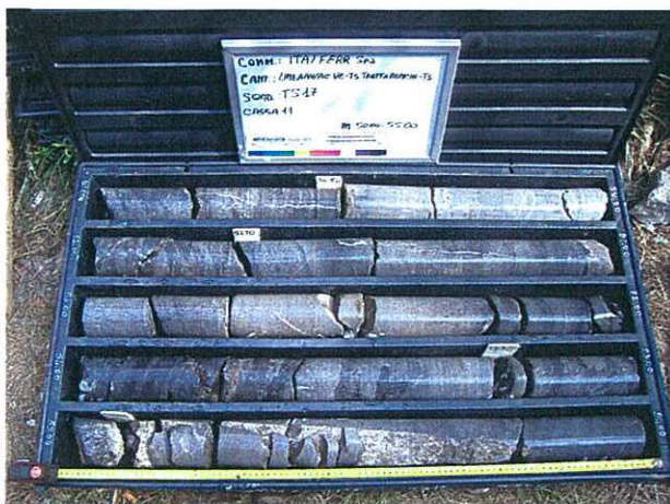
Fig. 9.1– Foto sondaggio TS17 a quota galleria (55m da p.c.) - Formazione Calcarei di Monte Coste - Calcarei neri
