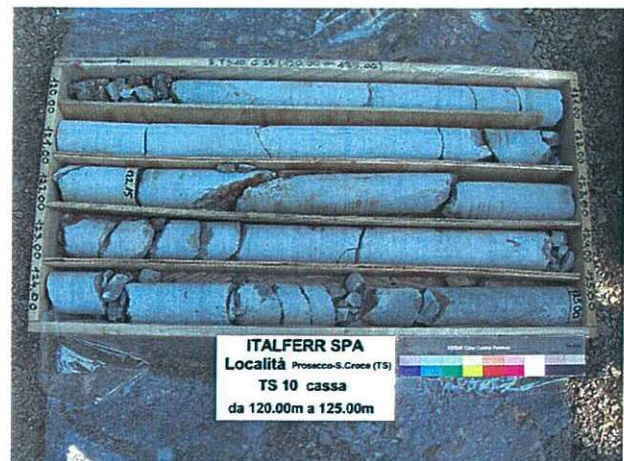
Fig. 9.5– Foto sondaggio TS10 a quota galleria (120m da p.c.) - Formazione Calcari Liburnici - Calcari
