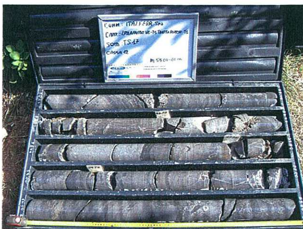
Fig. 9.1– Foto sondaggio TS17 a quota galleria (55m da p.c.) - Formazione Calcarei di Monte Coste - Calcarei neri
