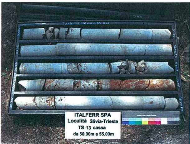
Fig. 9.2– Foto sondaggio TS13 a quota galleria (50m da p.c.) - Formazione di Monrupino - Dolomie e Calcarei
