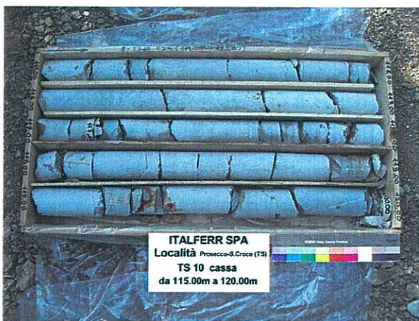
Fig. 9.5– Foto sondaggio TS10 a quota galleria (120m da p.c.) - Formazione Calcari Liburnici - Calcari
