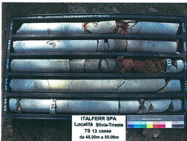
Fig. 9.2– Foto sondaggio TS13 a quota galleria (50m da p.c.) - Formazione di Monrupino - Dolomie e Calcarei
