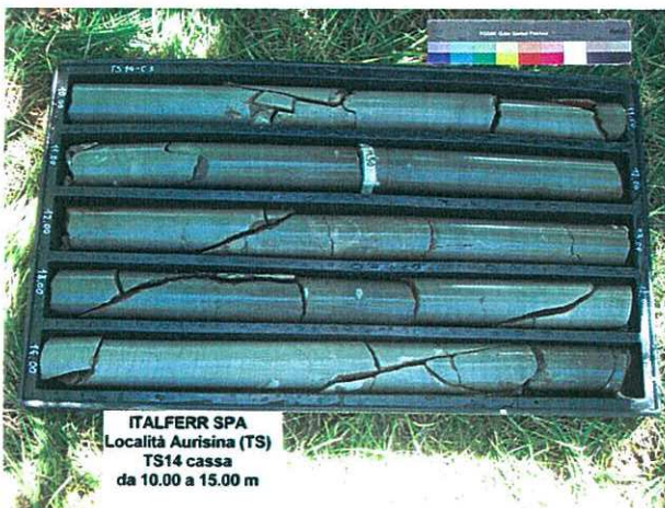
Fig. 9.4– Foto sondaggio TS14 a quota galleria (14m da p.c.) - Formazione Calcari di Aurisina - Calcari a Rudiste
