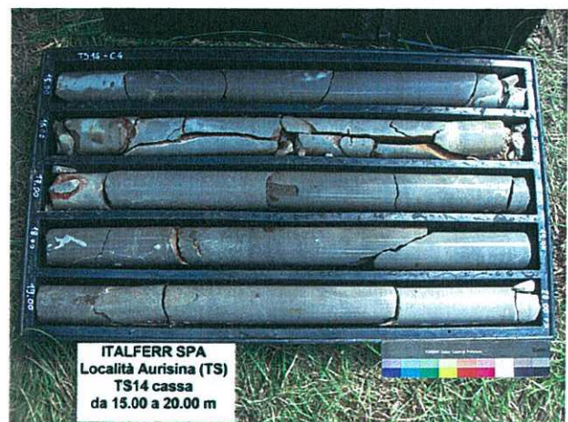
Fig. 9.4– Foto sondaggio TS14 a quota galleria (14m da p.c.) - Formazione Calcari di Aurisina - Calcari a Rudiste
