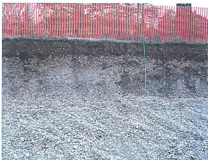
Depositi ghiaioso-sabbiosi soggiacenti a un suolo mediamente evoluto riconducibili alle Alluvioni della piana dell'Isonzo-Unità di Gorizia. Scavo presso Romans d'Isonzo (all'esterno dell'areale indagato)
