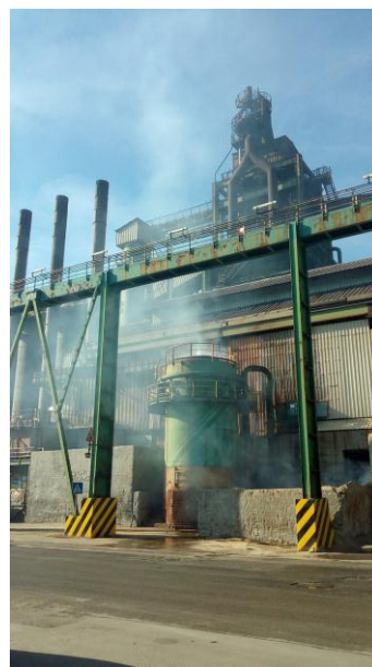
Foto 1. Episodio di accentuata fumosità in fase di granulazione della loppa proveniente dalla sommità della torre Ajo evidenziato nel corso dell'accesso in stabilimento del 23/09/2016, dovuto a un problema sul fine corsa della valvola di adduzione dell'acqua per l'abbattimento fumi.
