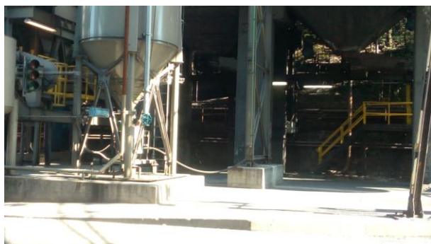
Foto 3. Nell'immagine di sinistra è riportato il silos dei carboni attivi con il relativo sistema di dosaggio. A destra vi è il particolare della valvola di intercetto chiusa del condotto di iniezione.
