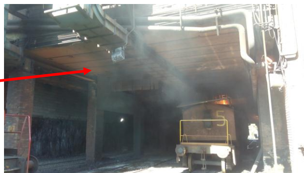
Foto 2. Episodio di elevata fumosità proveniente dalla parte superiore dei carri siluro in fase di travaso della ghisa liquida all'interno degli stessi, evidenziato nel corso dell'accesso in stabilimento del 28/09/2016.
