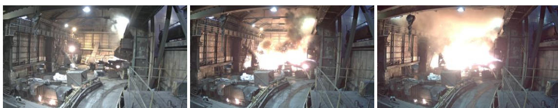
Foto 2. Sequenza con diversi fotogrammi a partire dall'inizio dell'evento anomalo fino alla fase di culmine ripresa dalla telecamera all'interno del piano di colata.
