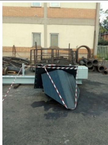
Deflettore nuovo, che consente la diffusione uniforme della carica all'interno dell'altoforno.
