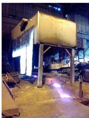
Particolari della nuova cappa di aspirazione e del nuovo profilo del canale di colata.
