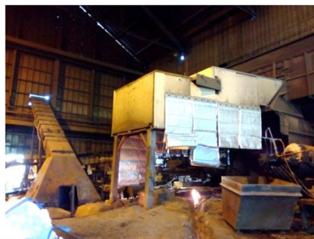
Particolari della nuova cappa di aspirazione e del nuovo profilo del canale di colata.
