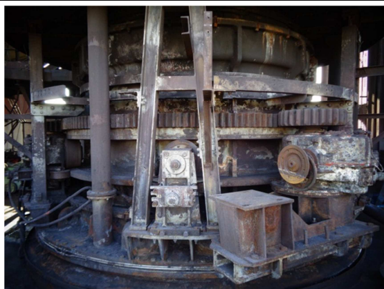
bocca di caricamento altoforno vecchia sostituita nel corso dell'ultima manutenzione (Foto del 27/09/2017)
