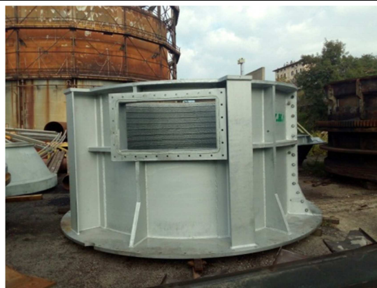
Bocca di carica nuova installata nell'ultima manutenzione.
