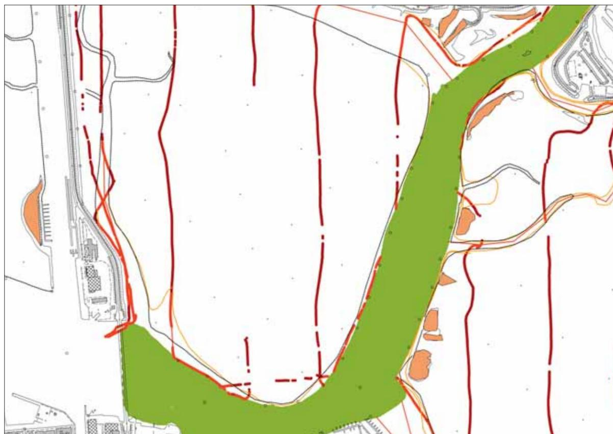
29. Esempio di elaborazione: in verde il rilievo multibeam, in rosso e rosso scuro i dati singlebeam e gli assi canale, isobate ausiliarie in giallo.
