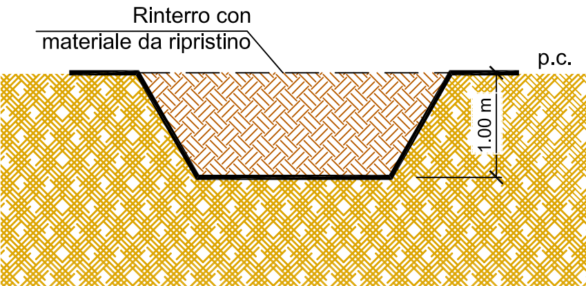
Particolare B: Scavo e smaltimento - Schema esemplificativo
