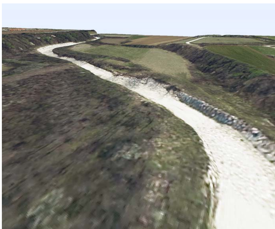
Figura 7.2.3: Modello virtuale del terreno ottenuto dalla sovrapposizione dell'ortofoto al DEM
