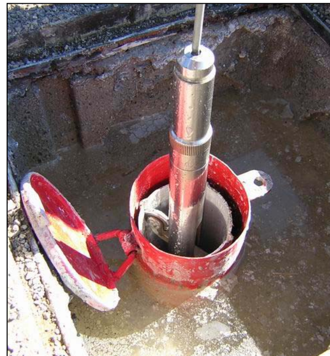
Fig.3: Sonda inclinometrica biassiale per profili lungo tubi di deformazione.
