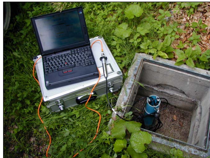
Fig.5: Scarico dati da piezometro per lo studio del livello della falda e delle acque sotterranee.
