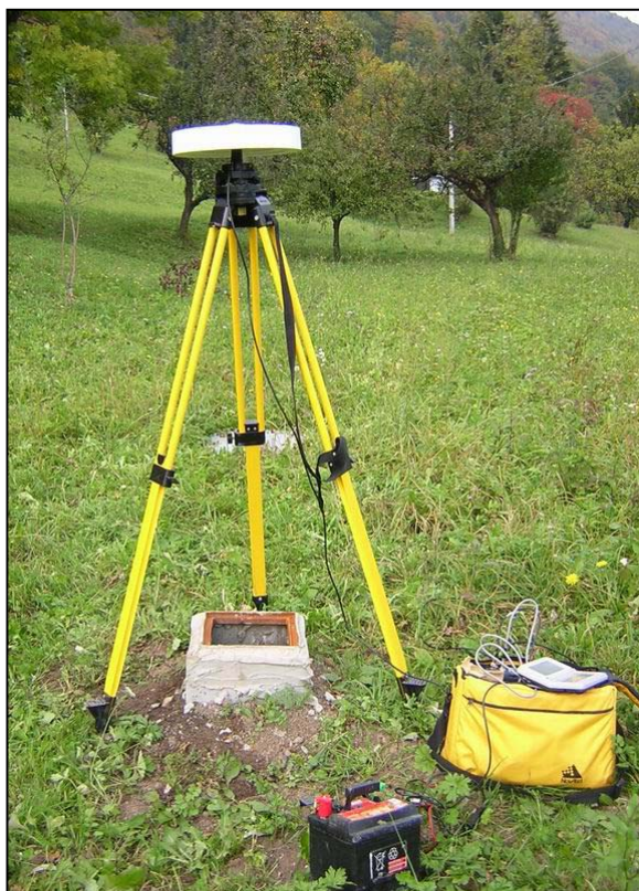
Fig.6: Misure topografiche satellitari GPS.
