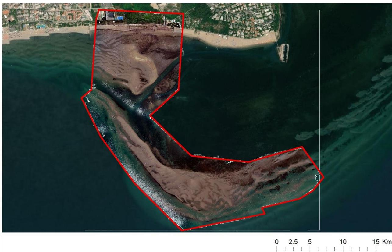
Figura 15 Ortofoto generata dal modello fotogrammetrico prodotto con le immagini del volo con l'APR
