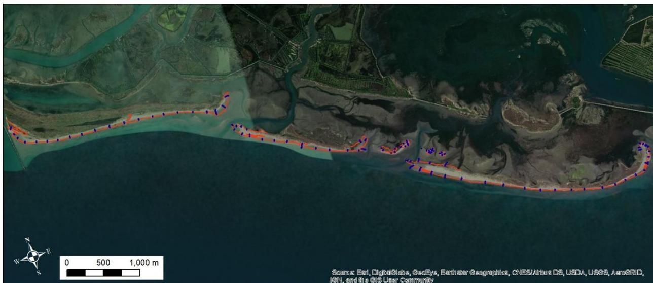
Figura 18 Rilievo della linea di riva dei banchi sabbiosi, in blu i profili di taratura.
