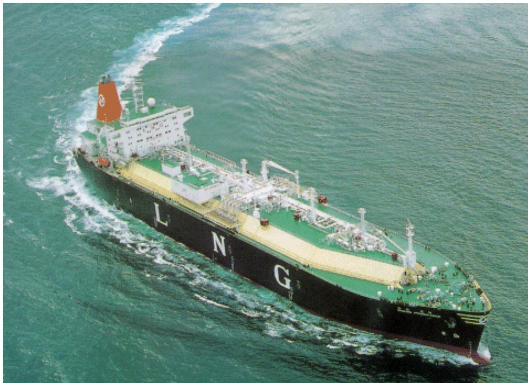
**Fig. 12.1** - Esempio di nave metaniera con serbatoi prismatici a membrana (tecnologia Gaztransport-Technigaz).
