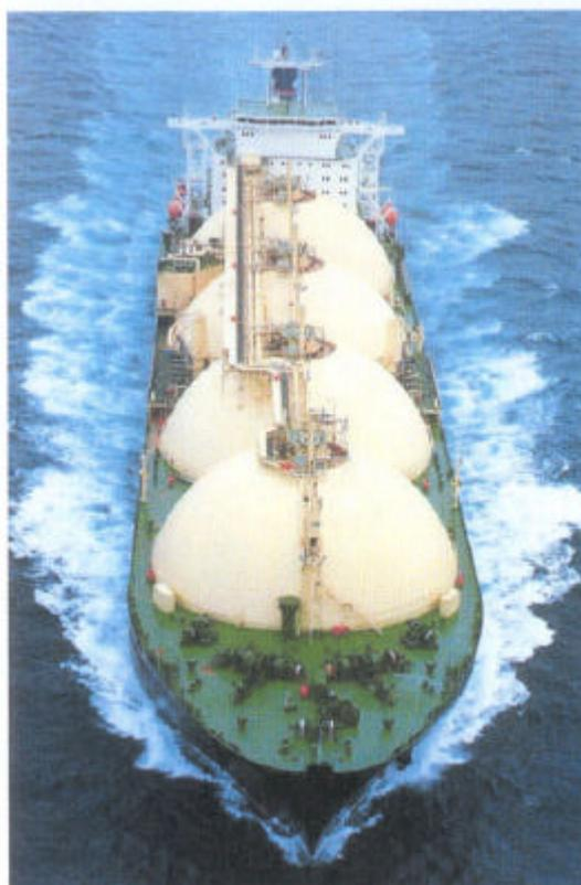
**Fig. 12.2** - Esempio di nave metaniera con serbatoi sferici (tecnologia Moss-Rosenberg).
