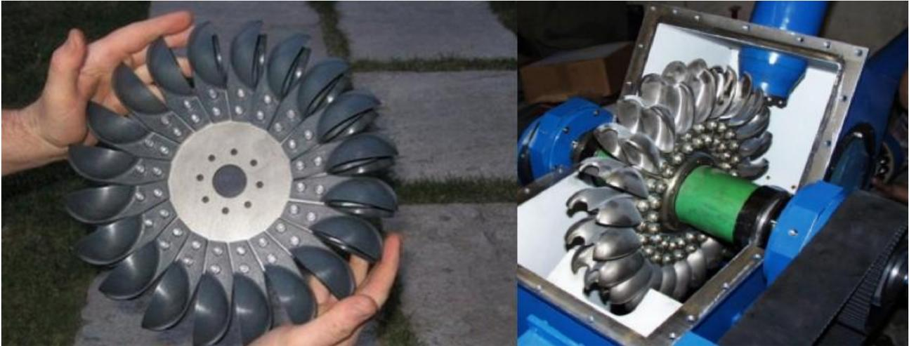
**Fig. 1:** turbine Pelton per impianti micro idro elettrici
