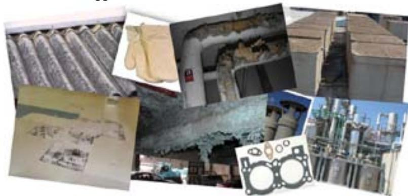
**Riconoscere l'amianto non è così difficile**, ad esempio è possibile notare l'affioramento di fasci di crisotilo e/o di crocidolite nei manufatti in cemento-amianto più deteriorati, come lastre ondulate, vasche per l'acqua potovana, fioriere, tubazioni per fumi o acqua potabile, ecc.
