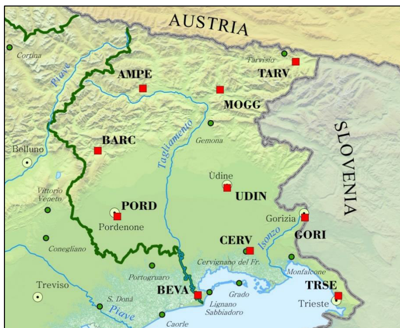
Fig. 1 – Disposizione delle stazioni GNSS della rete Marussi (quadrato rosso) sul territorio del Friuli Venezia Giulia.
