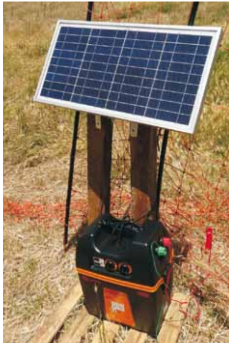
Un elettrificatore dotato di pannello solare per recinzione elettrificata
