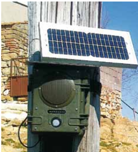
Esempio di dissuasore faunistico dotato di pannello solare
