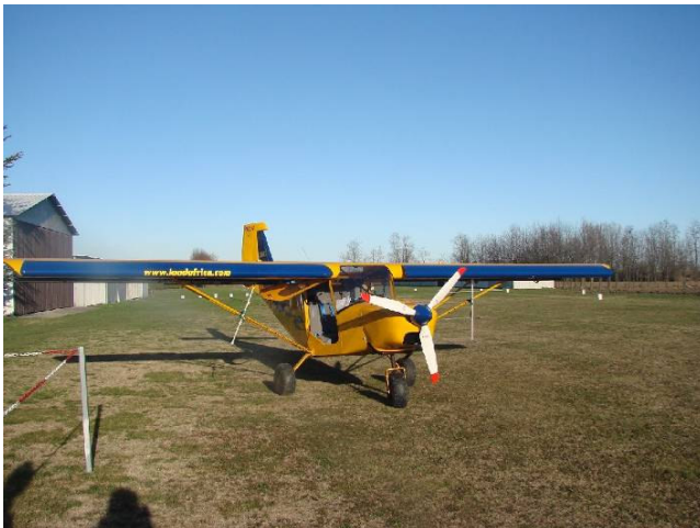
Figura 4.5.125. L'aeroplano ultraleggero utilizzato per i sorvoli della Laguna Nord e Sud; due antenne dual-Yagi sono fissate sul montante inferiore delle ali.
